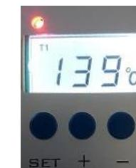
Для задания температуры необходимо нажать кнопку «SET» для переключения значения в верхней части дисплея с параметра «T1» (температура в реальном времени) на параметр «T2» (задаваемая температура), после чего выставляем нужную температуру используя кнопки «+» и «-» после чего снова нажмите кнопку «SET»
