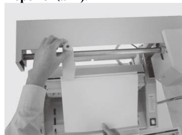
**7. Проклеить корешок блока (рис.) — провести kleepodavatелем по всей длине корешка и вернуть его в исходное положение.**
