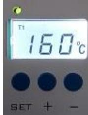
Для разогрева аппарата необходимо 15+25 минут (в зависимости от количества загруженного в kleopодаватель термоклея и его марки).
